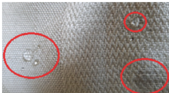
Permeabilidad del tejido de seda expuesto al rocío del agua, (Fuente Propia, fotografía de Janneth Vera, 2017)
