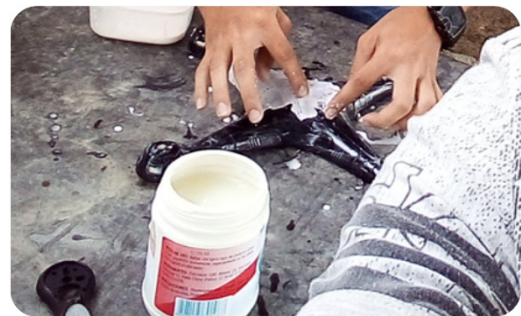
Figura 2. Fabricación por capas papel reciclable
