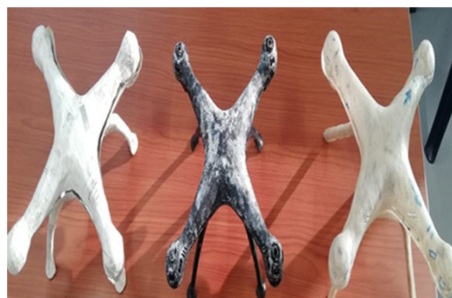
Figura 6. Izquierda chasis papel, derecha chasis de fibra de vidrio, el del medio original.
