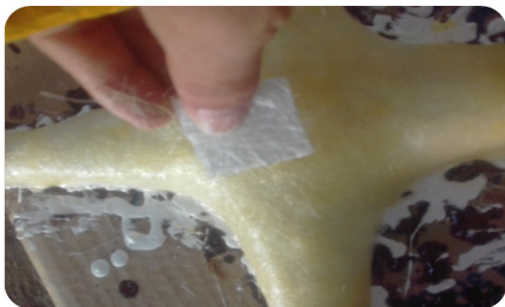
Figura 3. Fabricación capa por capa fibra de vidrio.
