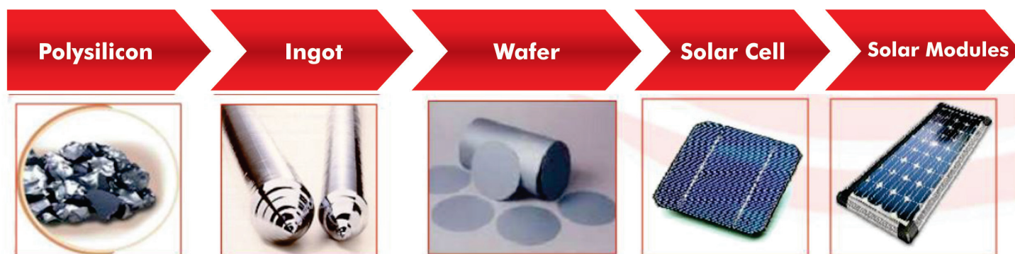
Figura 2: etapas de la fabricación de un panel de silicio policristalino
