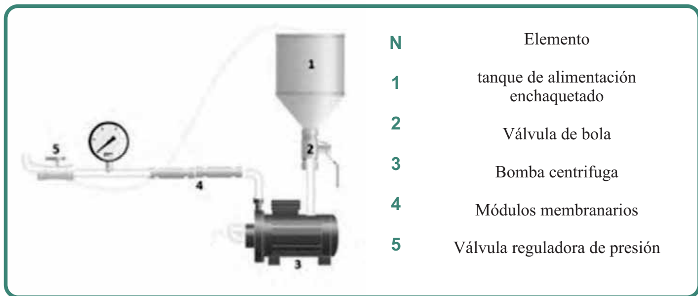
Figura 1. Piloto de filtración para membranas tubulares monocal.
