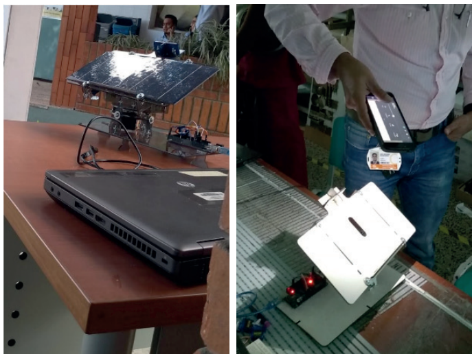
Imagen 5: pruebas con el prototipo ultimando detalles y versión final del seguidor hecha en acrílico. Fuente propia
