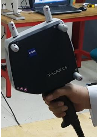
Ilustración 4. Escáner óptico de mano ZEISS T-SCAN CS
