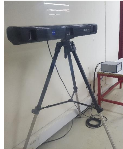
Ilustración 5. Sistema de seguimiento ZEISS T-TRACKER CS+ sobre trípode y orientado hacia zona de medición
