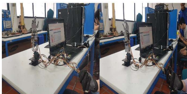
Fig. 7. Versión final del prototipo desarrollado y muestras de las ejecuciones de mandos a través de la lecturas registradas por los sensores de Velostat acoplados al guante. Fuente: Propia.
