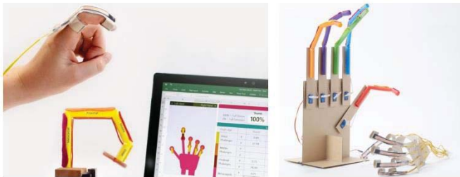
Fig. 3 Maqueta de Ejecución de mandos y guante con distribución de sensores de ADAFR-1361 -Velostat en los dedos del usuario. Fuente: Propia.
