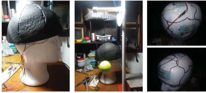
Fig. 3 Maqueta con distribución de sensores de ADAFR-1361 -Velostat. Fuente: Propia.
