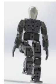
Figura No. 7: Diseño mecánico del robot Bioloid. Fuente: Autor.
