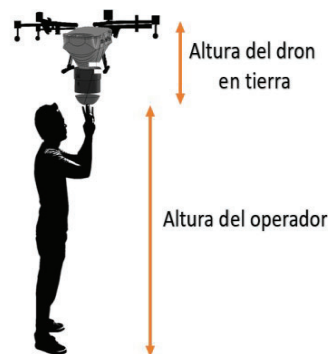
Figura No. 13: Posición y altura adecuada para el ensamblaje del disco giratorio con el dron en funcionamiento. Fuente: Propia
