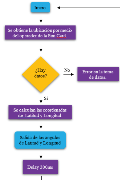
Figura No. 20: Diagrama de flujo para sensor GPS. Fuente: Propia.
