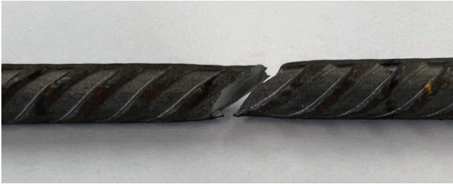
Fig. 7. Imagen de la zona de ruptura de la probeta en estado de entrega.
