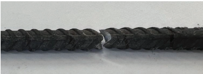
Fig. 9. Imagen de la zona de ruptura de la probeta templada y revenida.
