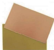
Figura 2. Placas conductoras de cobre
