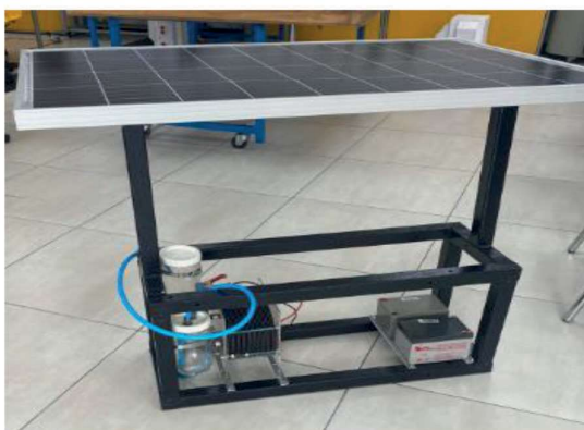
Figura 2. Sistema fotovoltaico seleccionado.
