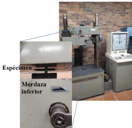
FIGURA 4. MONTAJE DEL ENSAYO A TENSIÓN (SHIMADZU)
