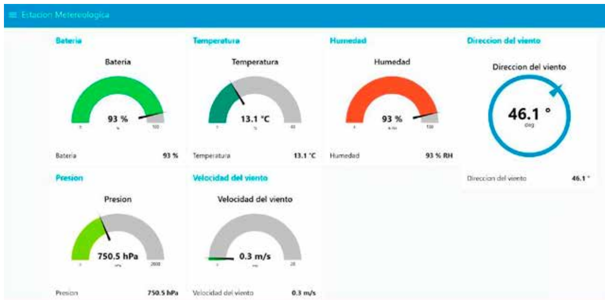
Figura 5. Dashboard realizado con Node Red. Fuente: Propia
