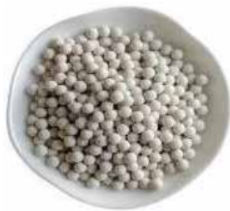
Figura 4. Bola de cerámica alcalina. Cortesía de Taiyuán Lanlang Tecnologías Industriales Corp.
