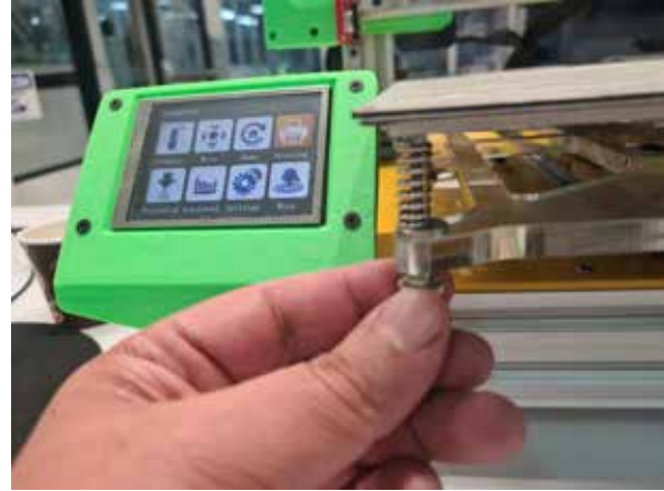
Figura 16. Nivelación de la cama
