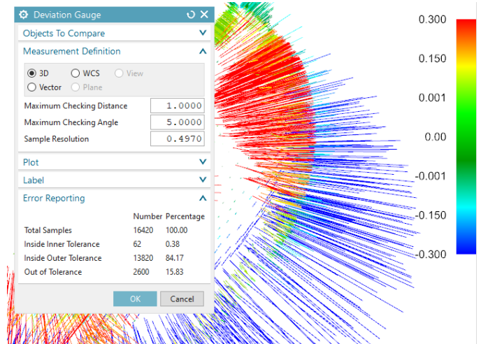
Figura 6. Reglaje de herramienta Deviation Gauge.
