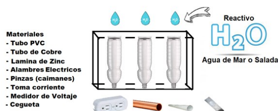
Figura No. 1: Materiales y reactivos utilizados para la fabricación del prototipo de baterías costeras basados en micro reactores de energías renovables. Fuente: propia
