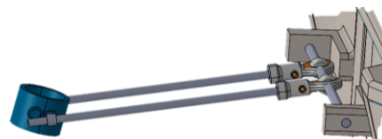
Figura No. 3: Sistema de acoplamiento del tanque a trenes de aterrizaje en drones. Fuente: Propia
