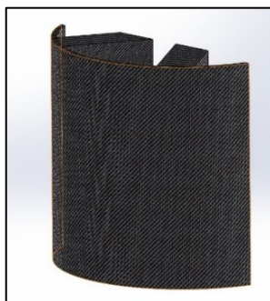
Figura No. 22: Diseño de la simulación de la pantalla LED curva en SolidWorks. Fuente: Propia
