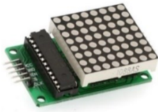
Figura No. 15: Módulo Matriz LED 8x8 MAX7219. Fuente: [13]
