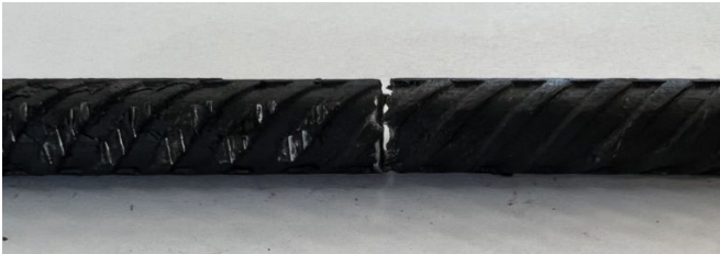
Fig. 8. Imagen de la zona de ruptura de la probeta templada.
