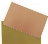
Figura 2. Placas conductoras de cobre
