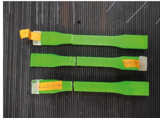
FIGURA 10. EJEMPLO ESPECÍMENES FACTURADOS
