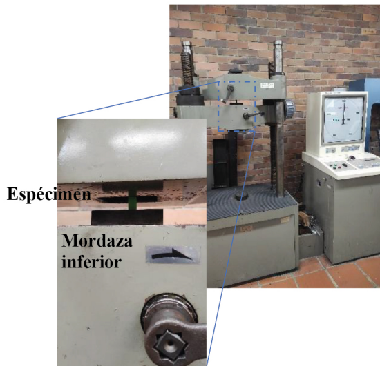
FIGURA 4. MONTAJE DEL ENSAYO A TENSIÓN (SHIMADZU)
