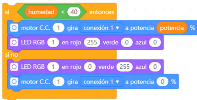
Figura 3. Módulo de control de humedad del suelo.
