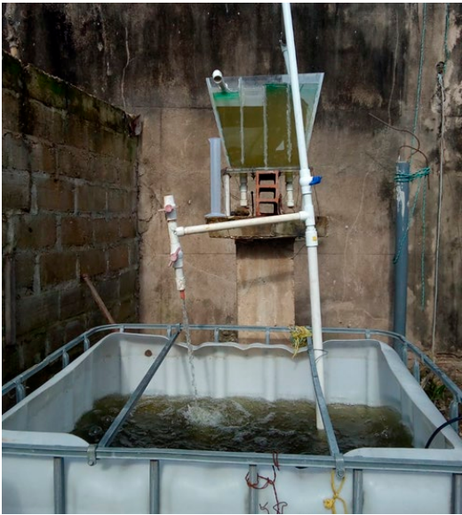
Figura 6a. Montaje completo prototipo de filtro y pecera a escala de laboratorio
