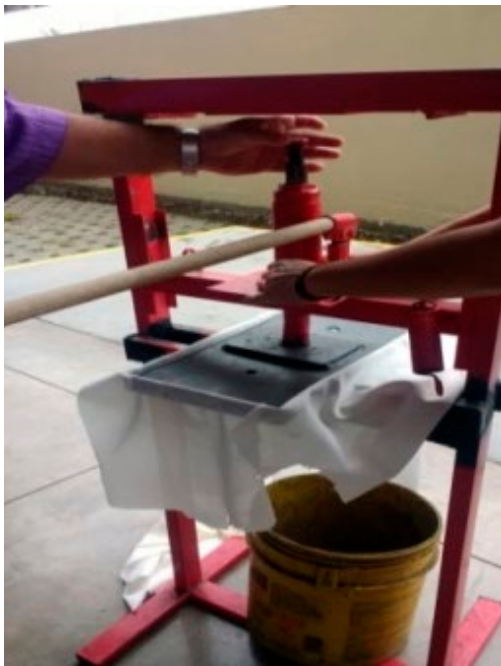
Figura 2. Sistema de prensado con gato hidráulico de botella
