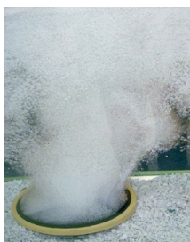
Figura 4. Domo cerámico en funcionamiento. Recuperado de: http://www.repicky.com.ar/images/difusor-de-burbuja-fina.jpg
