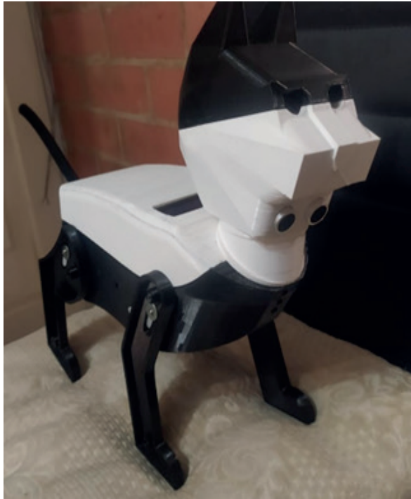
Figura 13: Impresión 3D y ensamble del robot completo.
