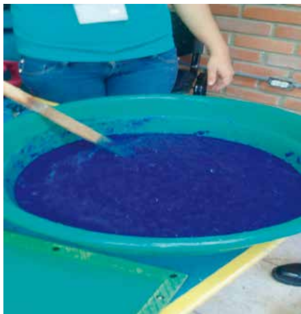
Imagen VI: Pigmentación de la Pulpa Celulosa con anilina azul.
