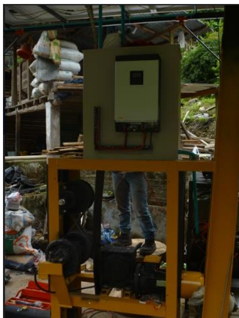
Figura 8. Prototipo implementado en la vereda San Jacinto de Gigante Huila – Sistema de tracción mecánica e inversor.
