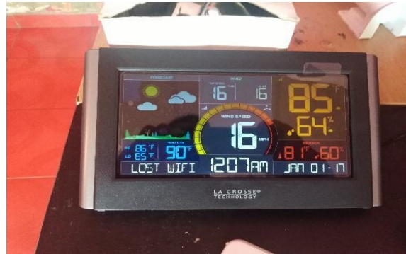
Figura 8. pantalla inalámbrica digital para sensores LaCrosse.
