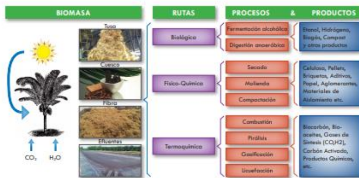
Figura 2. Propuesta de una biorrefinería aplicada a plantas de beneficio.
