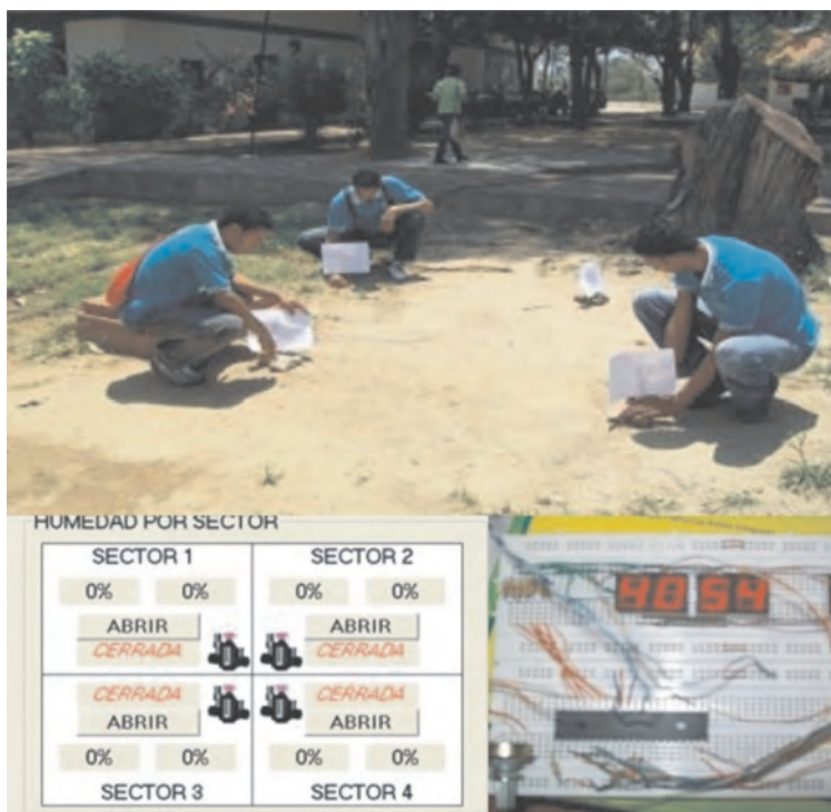
Figura 11. Pruebas de sensor de humedad y conexión con software de riego. Fuente: Elaboración propia (2014).
