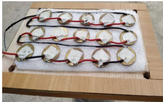
Figura 8. Base Inferior con el circuito principal de generación de energía. Fuente: Elaboración propia (2019)
