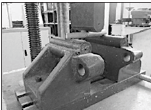
Foto 2. Montaje de prueba a flexión. Ensayo a flexión. Fuente: los autores.
