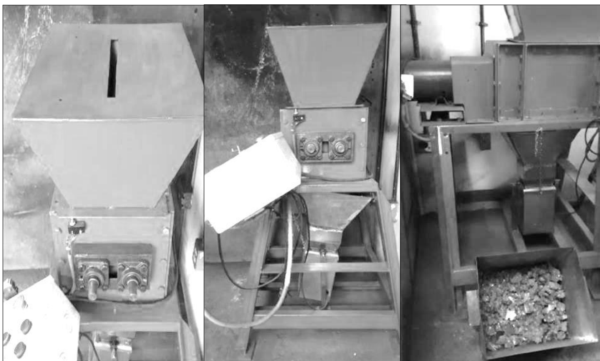
Figura 4. Trituradora de Tetra Pak SENA-CDA. Fuente: Elaboración propia.
