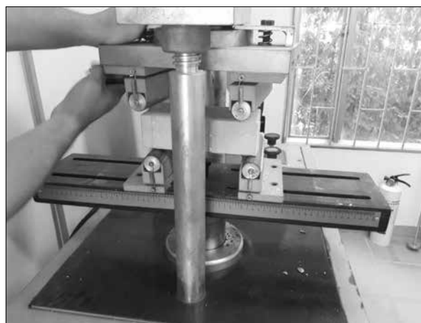
Foto 1: Ensayo de flexión en laboratorio. Fuente: elaboración propia.
