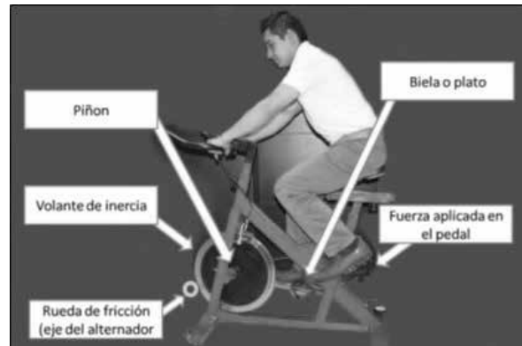
Figura 1. Selección de bicicleta estática convencional con especificación de partes mecánicas importantes. Fuente: Elaboración propia.
