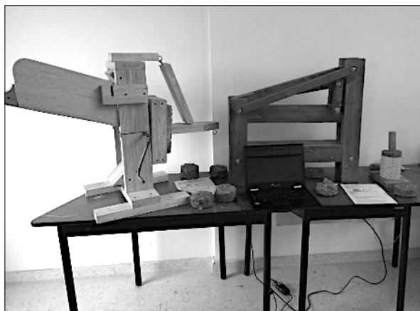
Figura 9. Modelo de prensa para conformación de las briquetas, para estufa Eco-eficiente. Fuente: Elaborado Grupo de Investigación GITAE ECOVIVIENDA, Chía Cundinamarca.
