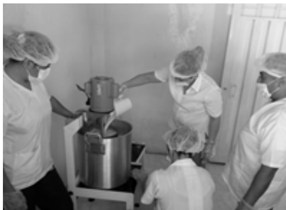
Figura 1. Proceso de quebrantado y separación de frijol de soya de la Unidad Productiva de Nilo.
