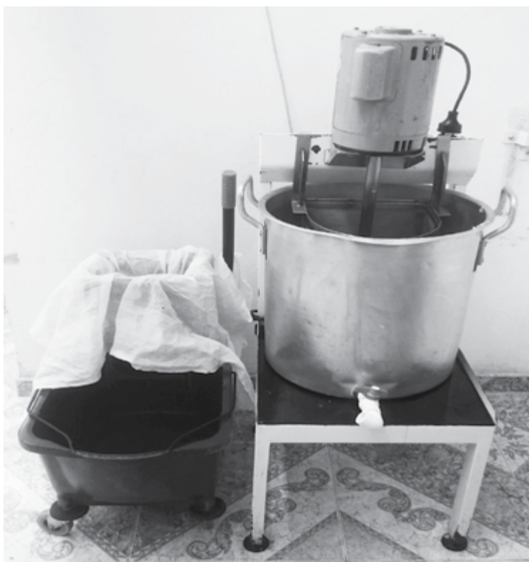
Figura 2. Equipo utilizado en la separación de masa y leche de soya. Unidad Productividad de Nilo.
