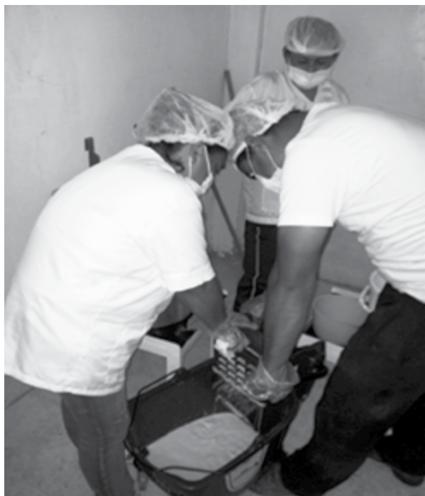
Figura 3. Separación a presión con lienzo y escurridor. Fuente: los autores.
