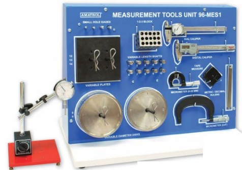
Figura 2. Banco de pruebas de medición de la empresa Amatrol.
