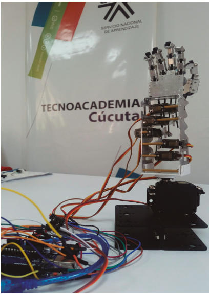
Figura 3. Ensamble de las piezas caracterizadas creando el prototipo de mano robotizada de 5 falanges
