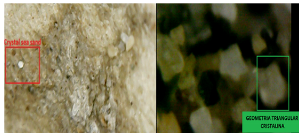
Figura 4 y 5. Efectividad de la sustancia hidrofóbica experimental (Izquierda). Muestra de resultados de verificación obtenidos para los cristales de \text{SiO}_2 (Derecha)
