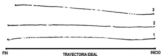
Figura 15. Prueba de desplazamiento en línea recta del robot construido
