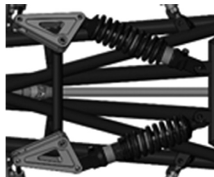
(c) Resortes, balancines, soportes en el chasis y acoples
