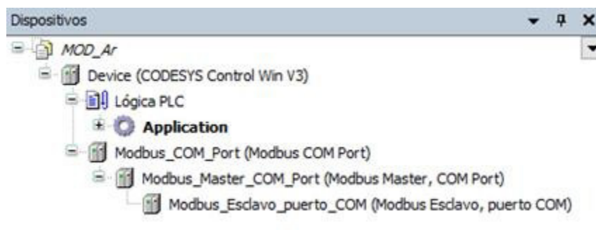
Figura 14. Adición de los dispositivos Modbus. Fuente: Los Autores.
