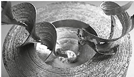
Broca tipo A Velocidad de corte: 10 m/min Avance: 0,03 mm
