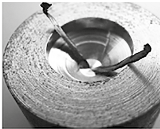
Broca tipo Standard de metal-duro Velocidad de corte: 10 m/min Avance: 0,03 mm
