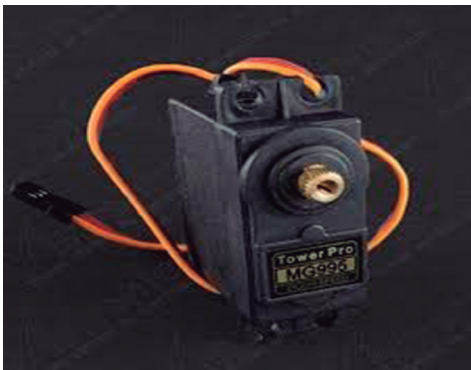
Figura 4. Servomotor utilizado MG995. Fuente. Autoría propia.
